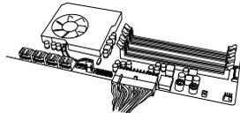
4. Schließen Sie das 4+4-Pin EPS12V-Kabel an das Motherboard an.
