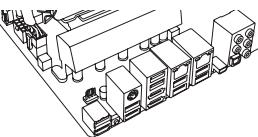
6. Conecte los cables 6/6+2-Pines PCI-E para la tarjeta gráfica(s).
