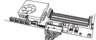
5. Schließen Sie das 4+4-Pin EPS12V-Kabel an das Netzteil und das Mainboard an. (**Optional**) – Wenn Sie **extremes Übertakten** beabsichtigen und Ihr Mainboard zusätzliche 8-Pin oder 4-Pin CPU-Netzstecker unterstützt, schließen Sie das zweite 4+4-Pin EPS12V-Kabel an. Dieses Kabel wird nur für extremes Übertakten, oder für Mainboards mit zwei CPUs benötigt.
