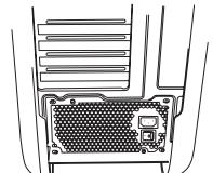
3. Use os parafusos fornecidos com o seu gabinete para instalar a fonte em seu computador. **NOTA:** Recomenda-se instalar a fonte de alimentação com a ventoinha voltada para baixo. No entanto, se o seu Gabinete o encaixe da fonte de alimentação é na parte de baixo e não existem orifícios de ventilação disponíveis, pode ser melhor instalar a fonte com a ventoinha voltada para cima para uma maior eficiência e confiabilidade.
