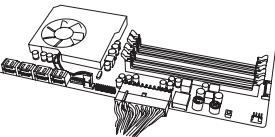
5. Conecte el cable EPS12V 4+4 clavijas de la fuente de alimentación y la placa madre. **(Opcional)** - Si usted planea en overclocking extrema y su placa base soporta 8-Pines adicionales o conectores de alimentación de CPU 4-Pines, conecte el segundo cable EPS12V 4+4-Pines. Esto sólo es necesario para el overclocking pesada o para placas base duales CPU.
