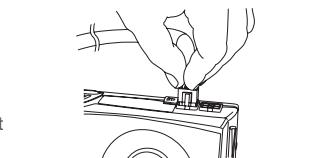
7. Schließen Sie die SATA-Netzkabel an alle Datenlaufwerke und optischen Laufwerke an. (Mainboards, Solid-State-Laufwerke (SSDs), optische Laufwerke)
