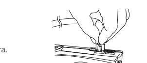
9. Подсоедините кабель питания к блоку питания и настенной розетке. Проверьте все подключения, убедившись в надежности соединений, и переведите расположенный на блоке питания выключатель питания в положение ON (ВКЛ.).
