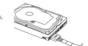
8. Conecte os "Molex" conectores de 4-Pin periféricos para ventiladores, bombas, componentes adicionais e outros dispositivos/adaptadores.
