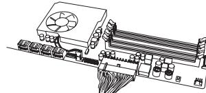
5. Conecte o cabo 4+4-Pin EPS12V de sua Fonte em sua placa-mãe. **(Opcional)** - Se você está pensando em realizar overclock e a sua placa-mãe suporta 8-Pin adicional ou conectores de alimentação da CPU de 4-Pin, conecte o segundo cabo EPS12V 4+4-Pin. Isso só é necessário para overclocking pesado ou para placas-mãe dual processadas. (Dual CPU)
