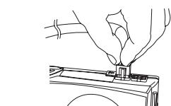
7. Conecte os cabos de energia SATA aos seus dispositivos (discos rígidos, SSDs e drives ópticos).
