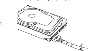
8. Schließen Sie die peripheren "Molex" 4-Pin-Stecker für Lüfter, Pumpen, ältere Komponenten und sonstige Geräte/Adapter an.
