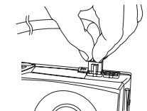
7. Collegare i cavi di alimentazione SATA a tutte le unità di dati o unità ottiche (hard disk, unità stato solido, unità ottiche).
