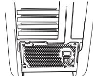
3. Utilice los tornillos suministrados con el caso de instalar la fuente de alimentación en el equipo. **NOTA:** Se recomienda la instalación de la fuente de alimentación con el ventilador hacia abajo. Sin embargo, si su caso coloca la fuente de alimentación en la parte inferior de la caja y no hay orificios de ventilación disponibles, puede ser mejor instalar la fuente de alimentación con el ventilador hacia arriba para una mayor eficiencia y fiabilidad.
