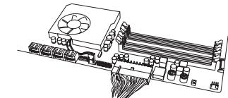
6. Collegare i cavi PCI-E 6/6+2 pin alla scheda grafica o schede grafiche. **NOTA:** non tentare di collegare un cavo PCI-E a 8 pin a un connettore a 6 pin senza prima rimuovere i due pin supplementari.
