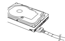
8. Schließen Sie die peripheren "Molex" 4-Pin-Stecker für Lüfter, Pumpen, ältere Komponenten und sonstige Geräte/Adapter an.
