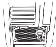
3. Utilice los tornillos suministrados con el caso de instalar la fuente de alimentación en el equipo. **NOTA:** Se recomienda la instalación de la fuente de alimentación con el ventilador hacia abajo. Sin embargo, si su caso coloca la fuente de alimentación en la parte inferior de la caja y no hay orificios de ventilación disponibles, puede ser mejor instalar la fuente de alimentación con el ventilador hacia arriba para una mayor eficiencia y fiabilidad.
