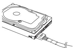
8. Conecte los conectores periféricos "Molex" 4-Pines para ventiladores, bombas, componentes heredados y otros dispositivos/adaptadores.
