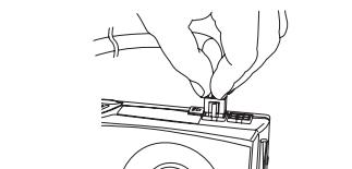
7. Collegare i cavi di alimentazione SATA a tutte le unità di dati o unità ottiche (hard disk, unità stato solido, unità ottiche).
