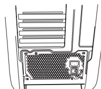
3. Verwenden Sie die mitgelieferten Schrauben, um das Netzteil in Ihrem Computer anzubringen. **HINWEIS:** Es wird empfohlen, das Netzteil mit dem Lüfter nach unten zu installieren. Hat das Gehäuse unten jedoch keine Lüftungsschlitzte, ist es effizienter das Netzteil an einer Stelle mit Lüftungsschlitzten anzubringen, um mehr Zuverlässigkeit und Kühlung zu gewährleisten.
