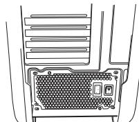
3. Для закрепления блока питания внутри корпуса компьютера используйте винты из комплекта поставки. **ПРИМЕЧАНИЕ.** Рекомендуется устанавливать блок питания таким образом, чтобы вентилятор был направлен лицевой стороной вниз. Однако, если блок питания должен быть размещен внизу корпуса компьютера, и при этом отсутствуют вентиляционные отверстия, то, возможно, для обеспечения более высокой эффективности и надежности лучше всего установить блок питания так, чтобы вентилятор был направлен вверх.
