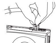
7. Schließen Sie die SATA-Netzkabel an alle Datenlaufwerke und optischen Laufwerke an. (Mainboards, Solid-State-Laufwerke (SSDs), optische Laufwerke)
