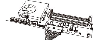
7. Collegare i cavi di alimentazione SATA a tutte le unità di dati o unità ottiche (hard disk, unità allo stato solido, unità ottica).
