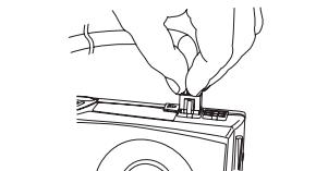
7. Conecte os cabos de energia SATA aos seus dispositivos (discos rígidos, SSDs e drives ópticos).
