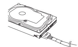
8. Schließen Sie die peripheren “Molex” 4-Pin-Stecker für Lüfter, Pumpen, ältere Komponenten und sonstige Geräte/Adapter an.
