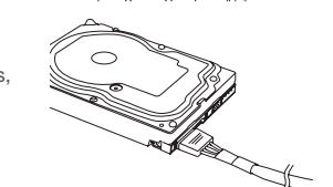
8. Conecte os "Molex" conectores de 4-Pin periféricos para ventiladores, bombas, componentes adicionais e outros dispositivos/adaptadores.
