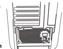
3. Use os parafusos fornecidos com o seu gabinete para instalar a fonte em seu computador. **NOTA:** Recomenda-se instalar a fonte de alimentação com a ventoinha voltada para baixo. No entanto, se o seu Gabinete o encaixe da fonte de alimentação é na parte de baixo e não existem orifícios de ventilação disponíveis, pode ser melhor instalar a fonte com a ventoinha voltada para cima para uma maior eficiência e confiabilidade.
