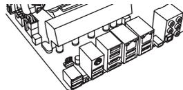
6. Collegare i cavi PCI-E 6/6+2 pin alla scheda grafica o schede grafiche. **NOTA:** non tentare di collegare un cavo PCI-E a 8 pin a un connettore a 6 pin senza prima rimuovere i due pin supplementari.
