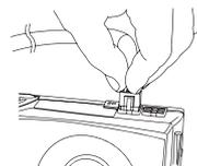
7. Schließen Sie die SATA-Netz Kabel an alle Datenlaufwerke und optischen Laufwerke an. (Mainboards, Solid-State-Laufwerke (SSDs), optische Laufwerke)
