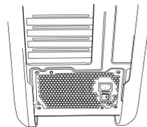
3. Utilisez les vis fournies avec le boîtier pour installer le bloc d'alimentation dans votre ordinateur. **REMARQUE:** nous vous recommandons d'installer le bloc d'alimentation avec le ventilateur orienté vers le bas. Cependant, si le bloc d'alimentation est installé dans la partie inférieure du boîtier et qu'il n'y a pas de trous d'aération, le mieux est de placer le bloc d'alimentation avec le ventilateur orienté vers le haut pour plus d'efficacité et de fiabilité.
