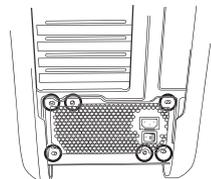
3. Utilizzare le viti fornite con il case per installare l'alimentatore nel proprio computer. **NOTA:** si raccomanda di installare l'alimentatore con la ventola rivolta verso il basso. Tuttavia, se nel case l'alimentatore è ubicato nella parte inferiore e fori di ventilazione non sono disponibili, è possibile installare l'alimentatore con la ventola rivolta verso l'alto per una maggiore efficienza e affidabilità.
