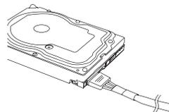
8. Conecte los conectores periféricos "Molex" 4-Pines para ventiladores, bombas, componentes heredados y otros dispositivos/adaptadores.
