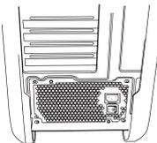
3. Utilice los tornillos suministrados con el caso de instalar la fuente de alimentación en el equipo. **NOTA:** Se recomienda la instalación de la fuente de alimentación con el ventilador hacia abajo. Sin embargo, si su caso coloca la fuente de alimentación en la parte inferior de la caja y no hay orificios de ventilación disponibles, puede ser mejor instalar la fuente de alimentación con el ventilador hacia arriba para una mayor eficiencia y fiabilidad.
