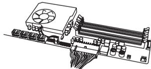
5. Collegare il cavo EPS12V da 4+4 pin alla scheda madre. **(Opzionale)** – se si intende utilizzare un **overclocking estremo** e la propria scheda madre supporta connettori per l'alimentazione della CPU a 8 pin o 4 pin, collegare il secondo cavo EPS12V da 4+4 pin. Questo è **solo** necessario per un overclocking estremo o per schede madri con doppia CPU.
