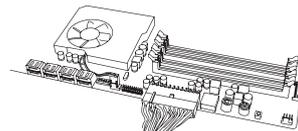
5. Schließen Sie das 4+4-Pin EPS12V-Kabel an das Netzteil und das Mainboard an. **(Optional)** – Wenn Sie **extremes Übertakten** beabsichtigen und Ihr Mainboard zusätzliche 8-Pin oder 4-Pin CPU-Netzstecker unterstützt, schließen Sie das zweite 4+4-Pin EPS12V-Kabel an. Dieses Kabel wird **nur** für extremes Übertakten und für Mainboards mit zwei CPUs benötigt.
