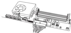
5. Conecte el cable EPS12V 4+4 clavijas de la fuente de alimentación y la placa madre. **(Opcional)** - Si usted planea en overlocking extrema y su placa base soporta 8 Pines adicionales o conectores de alimentación de CPU 4-Pines, conecte el segundo cable EPS12V 4+4-Pines. Esto sólo es necesario para el overlocking pesada o para placas base duales CPU.
