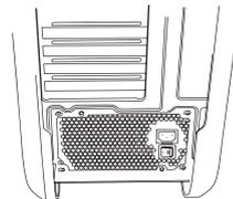
3. Verwenden Sie die mitgelieferten Schrauben, um das Netzteil im Computer zu anzubringen. **HINWEIS:** Es wird empfohlen, das Netzteil mit dem Lüfter nach unten zu installieren. Hat das Gehäuse unten jedoch keine Lüftungsschlitze ist es effizienter das Netzteil an einer Stelle mit Lüftungsschlitzen anzubringen, um mehr Zuverlässigkeit und Kühlung zu gewährleisten.
