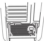
3. Utilice los tornillos suministrados con el caso de instalar la fuente de alimentación en el equipo. **NOTA:** Se recomienda la instalación de la fuente de alimentación con el ventilador hacia abajo. Sin embargo, si su caso coloca la fuente de alimentación en la parte inferior de la caja y no hay orificios de ventilación disponibles, puede ser mejor instalar la fuente de alimentación con el ventilador hacia arriba para una mayor eficiencia y fiabilidad.
