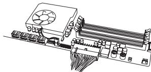
5. Conecte o cabo 4+4- Pin EPS12V de sua Fonte em sua placa-mãe. **(Opcional)** - Se você está pensando em realizar overclock e a sua placa-mãe suporta 8-Pin adicional ou conecto res de alimentação da CPU de 4-Pin, conecte o segundo cabo EPS12V 4+4-Pin. Isso só é necessário para overclocking pesado ou para placas-mãe dual processadas. (Dual CPU)
