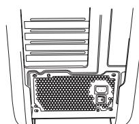
3. Verwenden Sie die mitgelieferten Schrauben, um das Netzteil in Ihrem Computer anzubringen. **HINWEIS:** Es wird empfohlen, das Netzteil mit dem Lüfter nach unten zu installieren. Hat das Gehäuse unten jedoch keine Lüftungsschlitzte, ist es effizienter das Netzteil an einer Stelle mit Lüftungsschlitzten anzubringen, um mehr Zuverlässigkeit und Kühlung zu gewährleisten.
