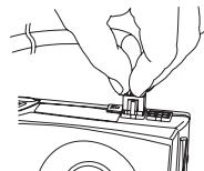
7. Schließen Sie die SATA-Netzkabel an alle Datenlaufwerke und optischen Laufwerke an. (Mainboards, Solid-State-Laufwerke (SSDs), optische Laufwerke)
