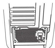
3. Utilizzare le viti fornite con il case per installare l'alimentatore nel proprio computer. **NOTA:** si raccomanda di installare l'alimentatore con la ventola rivolta verso il basso. Tuttavia, se nel case l'alimentatore è ubicato sulla parte inferiore e fori di ventilazione non sono disponibili, è possibile installare l'alimentatore con la ventola rivolta verso l'alto per una maggiore efficienza e affidabilità.
