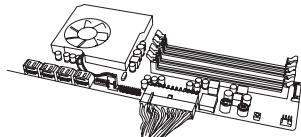
5. Schließen Sie das 4+4-Pin EPS12V-Kabel an das Netzteil und das Mainboard an. **(Optional)** – Wenn Sie **extremes Übertakten** beabsichtigen und Ihr Mainboard zusätzliche 8-Pin oder 4-Pin CPU-Netzstecker unterstützt, schließen Sie das zweite 4+4-Pin EPS12V-Kabel an. Dieses Kabel wird nur für extremes Übertakten, oder für Mainboards mit zwei CPUs benötigt.
