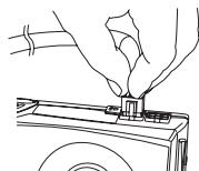
7. Conecte os cabos de energia SATA aos seus dispositivos (discos rígidos, SSDs e drives ópticos).
