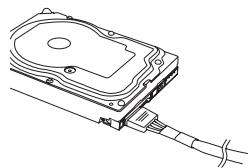
8. Schließen Sie die peripheren "Molex" 4-Pin-Stecker für Lüfter, Pumpen, ältere Komponenten und sonstige Geräte/Adapter an.
