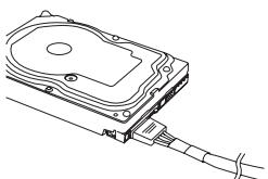
8. Conecte los conectores periféricos "Molex" 4-Pines para ventiladores, bombas, componentes redondos y otros dispositivos/adaptadores.
