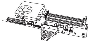
5. Conecte el cable EPS12V 4+4 clavijas de la fuente de alimentación y la placa madre. **(Opcional)** - Si usted planea en overclocking extrema y su placa base soporta 8-Pines adicionales o conectores de alimentación de CPU 4-Pines, conecte el segundo cable EPS12V 4+4-Pines. Esto sólo es necesario para el overclocking pesada o para placas base duales CPU.
