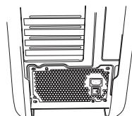
3. Use os parafusos fornecidos com o seu gabinete para instalar a fonte em seu computador. **NOTA:** Recomenda-se instalar a fonte de alimentação com a ventoinha voltada para baixo. No entanto, se o seu Gabinete o encaixe da fonte de alimentação é na parte de baixo e não existem orifícios de ventilação disponíveis, pode ser melhor instalar a fonte com a ventoinha voltada para cima para uma maior eficiência e confiabilidade.
