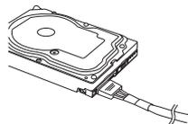
8. Sluit de perifere "Molex" 4-pins aansluitingen aan voor ventilatoren, pompen, oude componenten en andere apparaten/adapters.
