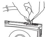
7. Sluit de SATA-voedingskabels aan op alle datadrives of optische stations. (harde schijven, solid state drives, optische schijven).
