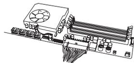
5. Podłącz 4+4-stykowy kabel EPS12V do płyty głównej.
