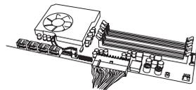
5. Schließen Sie das 4+4-Pin EPS12V-Kabel an das Netzteil und das Mainboard an. **(Optional)** – Wenn Sie **extremes Übertakten** beabsichtigen und Ihr Mainboard zusätzliche 8-Pin oder 4-Pin CPU-beabsichtigen und Ihr Mainboard zusätzliche 8-Pin oder 4-Pin CPU- Kabel an. Dieses Kabel wird nur für extremes Übertakten, oder für Mainboards mit zwei CPUs benötigt.
