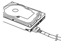
7. Schließen Sie die SATA-Netzkabel an alle Datenlaufwerke und optischen Laufwerke an. (Mainboards, Solid-State-Laufwerke (SSDs), optische Laufwerke)
