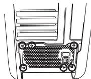
4. Sluit de 24-pins ATX-kabel aan op de PSU en het moederbord.
