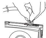
7. Podłącz kable zasilające SATA do wszystkich napędów danych lub napędów optycznych (dyski twarde, dyski półprzewodnikowe, napędy optyczne).
